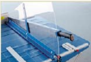
Protección para cuchilla mediante lámina de plexiglás
