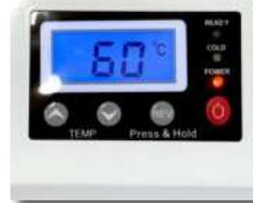
Equipada con **regulador de temperatura** en la pantalla LCD. Si se modifica, la máquina se desconecta hasta alcanzar la temperatura indicada.
